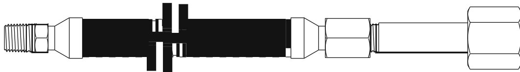
Figure 6. Flexible de liaison avec raccord pour bouteille.
